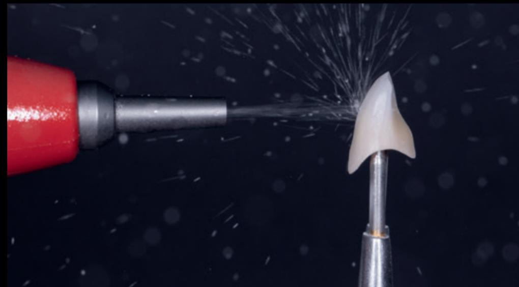
2. Para a limpeza e melhor molhabilidade da superfície, a restauração é jateada com óxido de alumínio. Granulometria recomendada: 50–110  $\mu\text{m}$  com um máx. de 1,5 bar.
